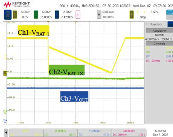
图14 Pulse 2b抗扰度测试波形（基于客户滤波电路）
