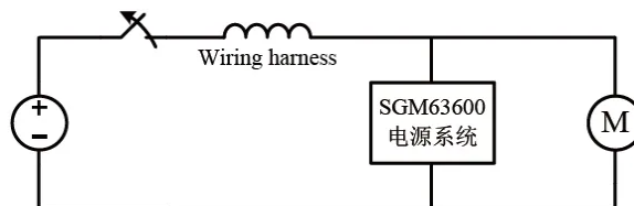
图12 Pulse 2b产生电路框图 [2]
