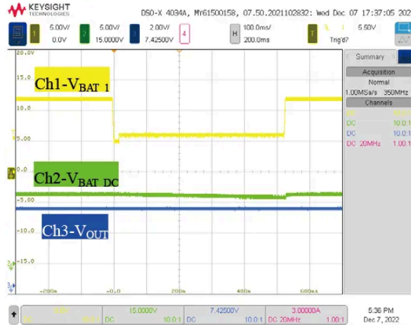
图26 Pulse 4抗扰度测试波形（基于客户滤波电路）
