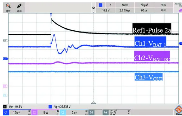
图11 Pulse 2a抗扰度测试波形（基于简化滤波电路）
